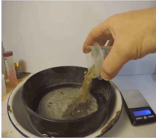
Figura 12. Adición de suelo grueso (con un pretamizado a ~10 mm) al tamiz de 2 mm en un recipiente con agua.
