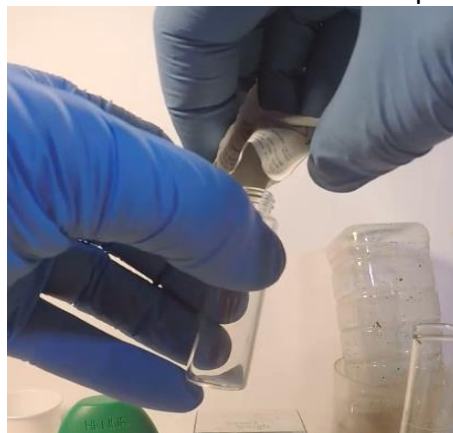
Figura 35. Agregar el paquete de reactivo al frasquito limpio.
