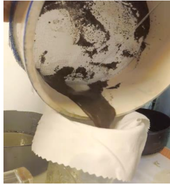
Figura. 15. Lavado de la fracción de tamaño 250 micrones a 2mm hacia un embudo con un paño para colar, secar, y pesar.
