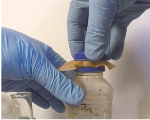
Figura 30. Añadir el papel de filtro doblado bajo la tapa de la botella
