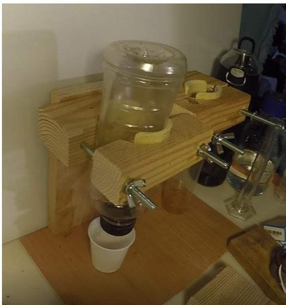
Figura 32. Una prensa para las botellas para filtración, que permite mantener alta presión sobre las botellas y utilizar un filtro de laboratorio o un filtro de café para sacar las arcillas del extracto. Ahorra tiempo porque al momento de presar se puede continuar con otros pasos de la medición o con otras muestras.
