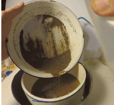
Figura 20. Transferir el material que pasa el tamiz de 2 mm hacia el tamiz de 250 micrones.
