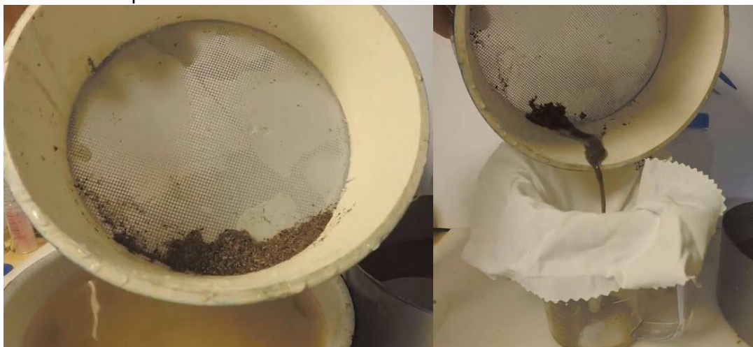
Figura 22. Izquierda: decantado MOP de 250 micrones en un borde del tamiz. Derecha: transferir a un paño absorbente para la visualización y/o secado del MOP.
