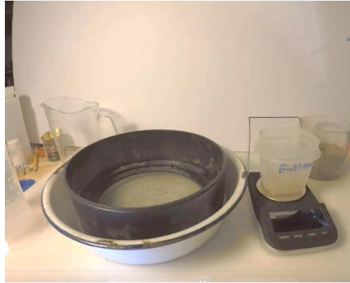
Figura 17. Preparación de la medición de MOP con el método normal, con un tamiz de 2 mm en un cubo de agua.
