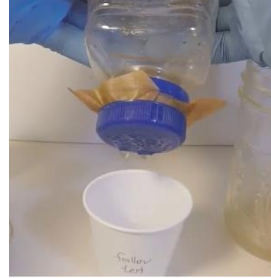
Figura 31. Presionando gotas claras de líquido a través del filtro a un vaso plástico.
