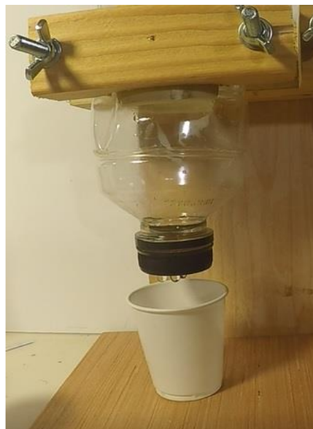
Figura 32. Una prensa para las botellas para filtración, que permite mantener alta presión sobre las botellas y utilizar un filtro de laboratorio o un filtro de café para sacar las arcillas del extracto. Ahorra tiempo porque al momento de presar se puede continuar con otros pasos de la medición o con otras muestras.
