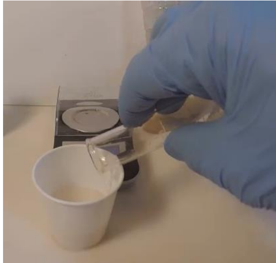
Figura 33. Añadir 7 ml de filtrado a 3,25 mL de solución \text{NaHSO}_4 para acidificar, anotar la efervescencia del extracto de suelo amarillo.
