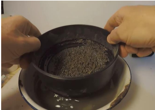
Figura 13. Levantar y hundir el tamiz en el agua 50 veces en 2 minutos.
