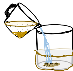
Fig. 6b. Decantar la materia orgánica que está flotando sobre la arena después de remover el agua.
