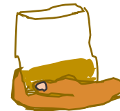
Fig. 4. Romper con la mano los agregados pequeños o 'migas' de arcilla dentro de la bolsa.
