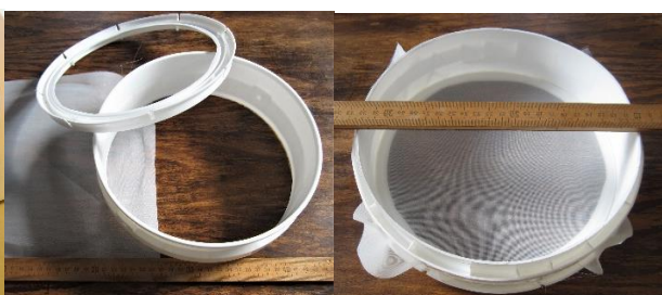
Figure 3. Tamis de 0,25 mm ou 250 microns pour la deuxième étape de tamisage dans l'eau, réalisé à partir du dessus et du couvercle d'un seau en plastique, diamètre compris entre 20 et 25 cm.
