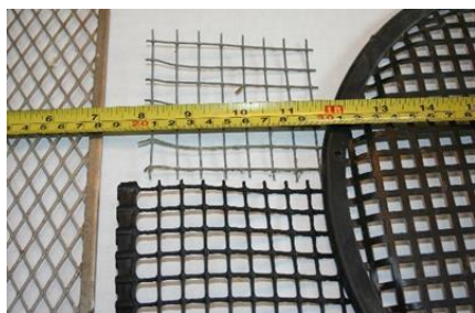
Figure 1. Options de mailles grossières entre 8 et 12 mm pour laisser passer les gros agrégats avant de sécher le sol.
