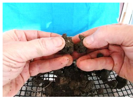
Figure 4. Casser de gros agrégats le long des fractures naturelles du sol, pour faire des agrégats qui passent la maillage grossier (8-12 mm)
