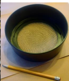
Figure 2. Tamis de 2 mm pour la première étape de tamisage dans l'eau.
