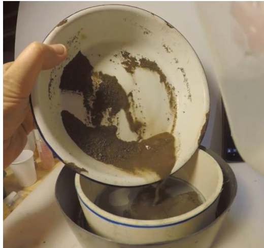
Figura 14. Enjuagar la fracción de tamaño <2 mm hacia el tamiz de 250 micrones.
