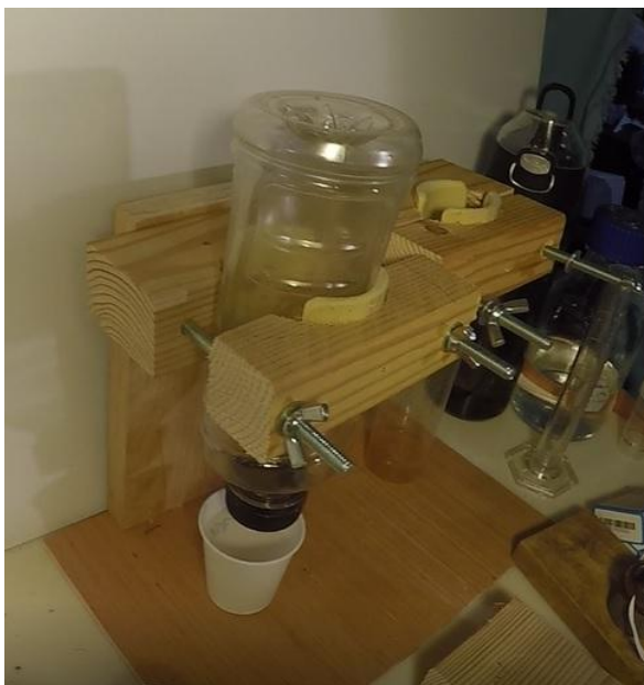
Figura 32. Una prensa para las botellas para filtración, que permite mantener alta presión sobre las botellas y utilizar un filtro de laboratorio o un filtro de café para sacar las arcillas del extracto. Ahorra tiempo porque al momento de presionar se puede continuar con otros pasos de la medición o con otras muestras.
