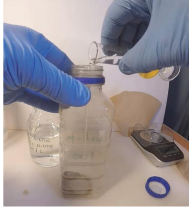
Figura 29. Añadir 25 mL de solución de Olsen a 2,5 g de suelo en una botella de jugo reutilizada.
