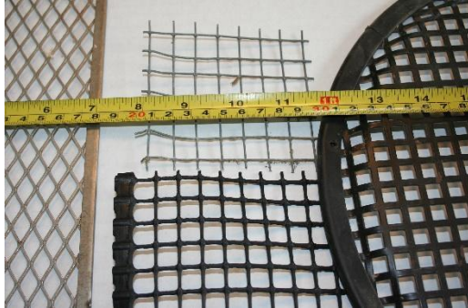
Fig. 10. Ejemplos de diferentes tipos de malla que se pueden utilizar para el pretamizado de suelo en seco, con un tamaño de entre 8 y 12 mm.
