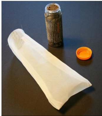
Figura R1. La bolsa de malla y una botella de tamaño adecuado para 100g de suelo, con agujeros de 2 mm hechos con un taladro o un clavo caliente.
