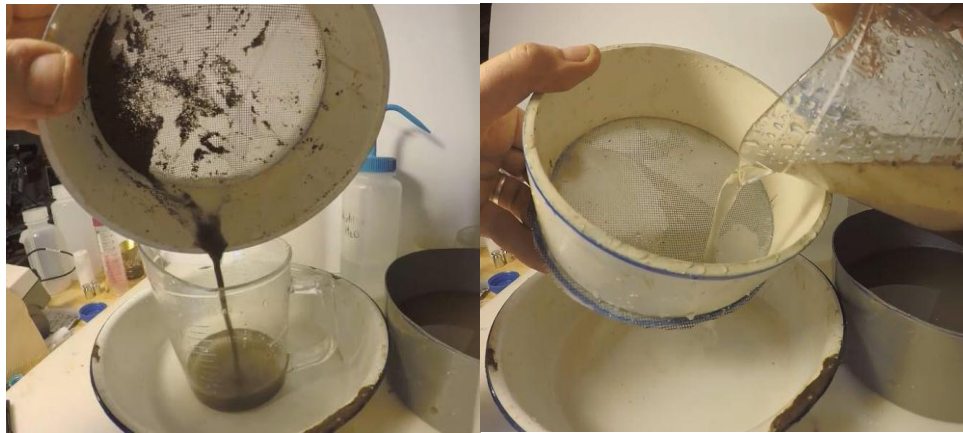
Figura 21. Izquierda: Transferir el material del tamiz de 250 micrómetros (mineral mezclado con MOP) a un vaso de precipitados para la decantación de la materia orgánica. Derecha: Decantación del MOP de 250 micrones a un rincón del tamiz de 250 micrones (en un borde del tamiz para facilitar mover el MOP a un embudo para el secado)
