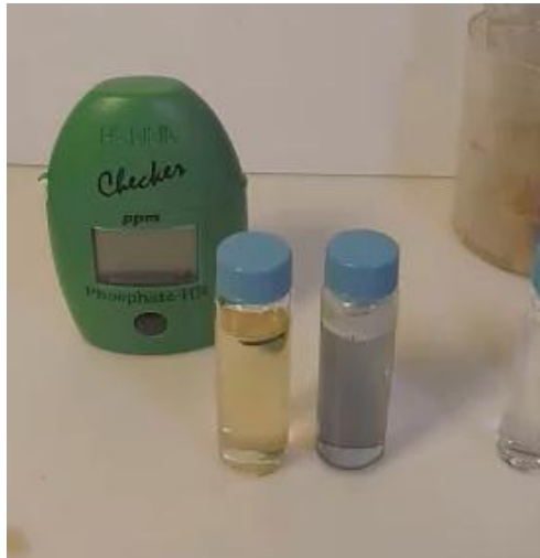
Figura 36. El color azul que se desarrolla en el extracto. El otro frasquito, con color amarillo, es el blanco o punto de comparación para el colorímetro.
