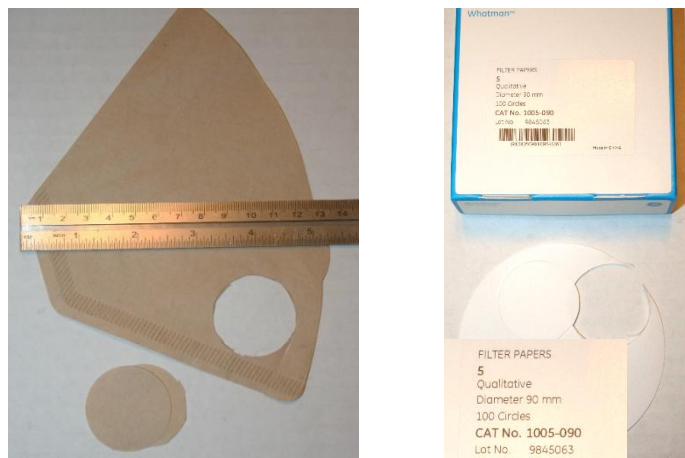
Fig. 4. Izquierda: Filtros de café en forma de cono; Derecha: filtros de laboratorio, Whatman tipo #5 con poros de 2,5 micrones. Círculos de ~3cm se cortaron de cada uno para filtrar suspensiones de suelo con una botella.
